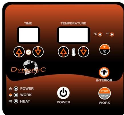
**Power On/Off (Encendido/ Apagado):** Presione para controlar la fuente de alimentación principal del sauna
