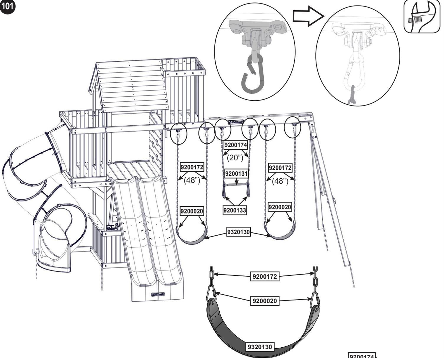
**Precaución:** Los mosquetones con rosca se deben instalar con la abertura completamente hacia abajo, cubriendo las roscas, y deben apretarse según se indica.
