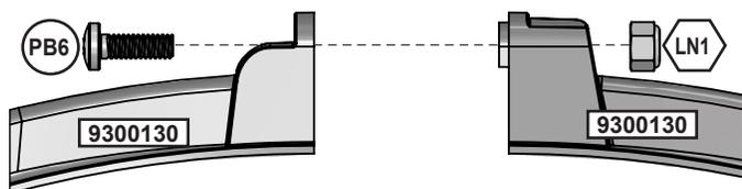
Una vez que las abrazaderas hayan quedado unidas a los codos, fijelas por los dos extremos con dos pernos de cabeza alomada y tuercas de seguridad.
