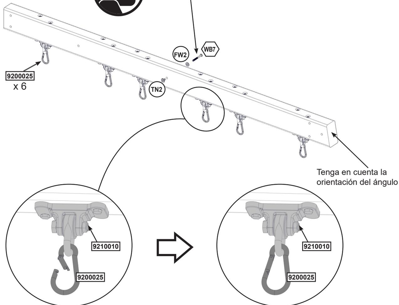
**Precaución:** El mosquetón con resorte debe ir fijado al soporte para columpio de gran resistencia en posición cerrada.
